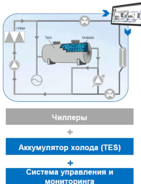
**Рисунок А.5 – Система управления холодильных машин с аккумуляторами холода**
