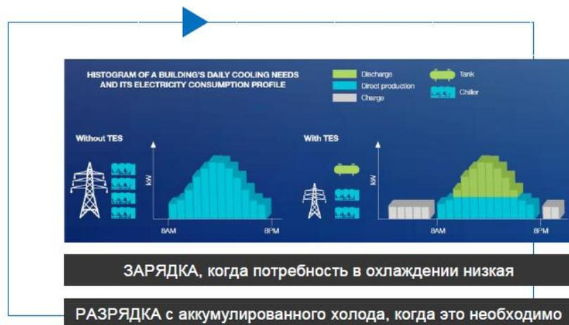
**Рисунок А.6 – Режим работы холодильных машин с аккумуляторами холода**
