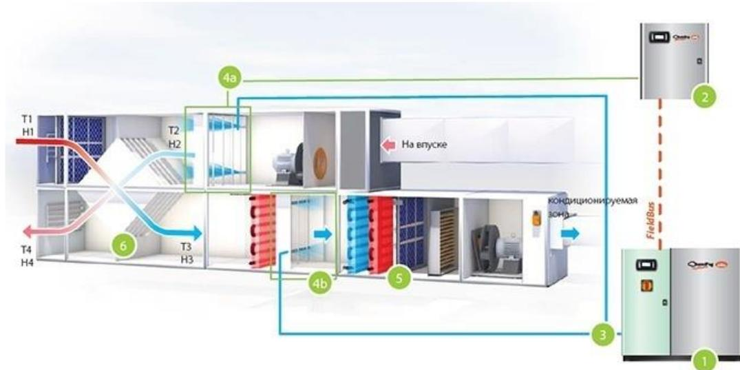
1 – насосная установка и зональный контроллер для увлажнения зимой; 2 – зональный контроллер для охлаждения летом; 3 – линия подачи воды под давлением; 4a – стойка для охлаждения летом; 4b – стойка для увлажнения зимой; 5 – каплеотделитель; 6 – установка рекуперации тепла
