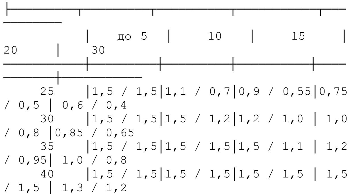
Примечания. 1. В числителе приведена допустимая скорость теплоносителя при применении кранов пробочных, трехходовых и двойной регулировки, в знаменателе - при применении вентилей.
