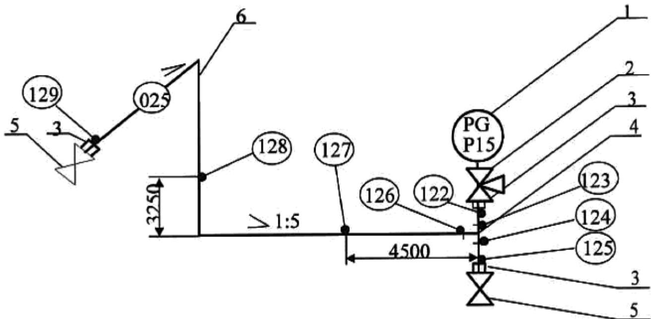
○ Номера сварных швов по журналу сварки трубопроводов
