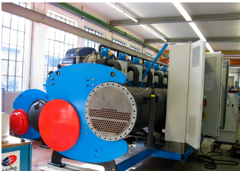
Чиллер на турбокомпрессорах с водяным охлаждением конденсатора в процессе сборки
